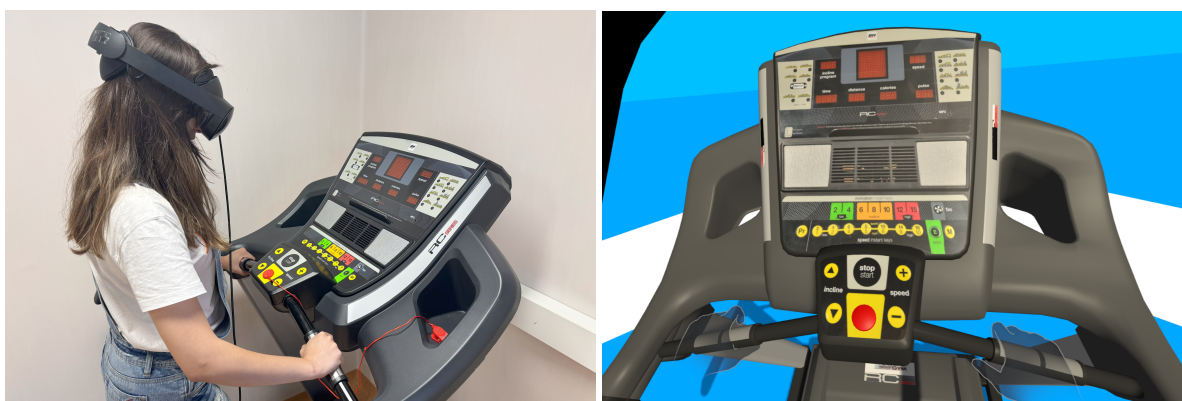
Figura 3: Calibración para establecer la correspondencia entre la cinta de correr virtual y la real
